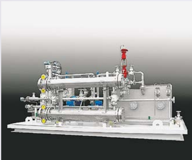
Ölversorgungsanlage
